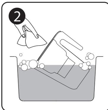
3. Опустите картридж фильтра в чистую воду на 15 минут. Слегка встряхните картридж, чтобы удалить угольный порошок с его поверхности.
